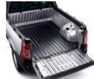
Praktisch und sehr stabil: Die Ladeklappe trägt 300 kg. Insgesamt 14 Verzurrpunkte an den Wänden der Ladefläche helfen beim sicheren Verstauen.
