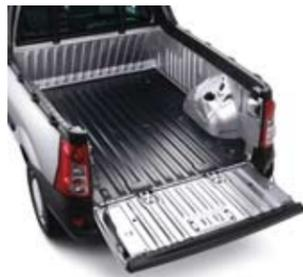
Praktisch und sehr stabil: Die Ladeklappe trägt 300 kg. Insgesamt 14 Verzurrpunkte an den Wänden der Ladefläche helfen beim sicheren Verstauen.
