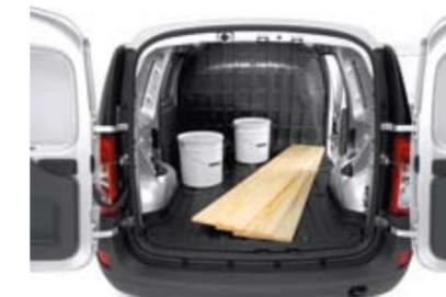
Verblechte Hecktüren, die geschlossene Trennwand zur Fahrerkabine\* und die Verzurrösen sorgen für einen sicheren Transport Ihrer wertvollen Fracht.
