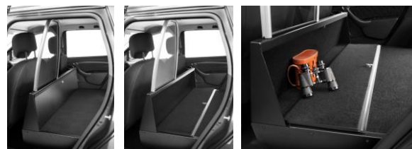
Praktisk aflåst opbevaringsrum i varemumsadskillelsen (tilbehør). Dimensioner: L = 129 cm, H = 28 cm, D (bund) = 12 cm, D (top) = 3 cm.
