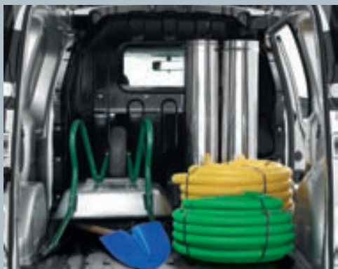
Cloison complète vitrée.
