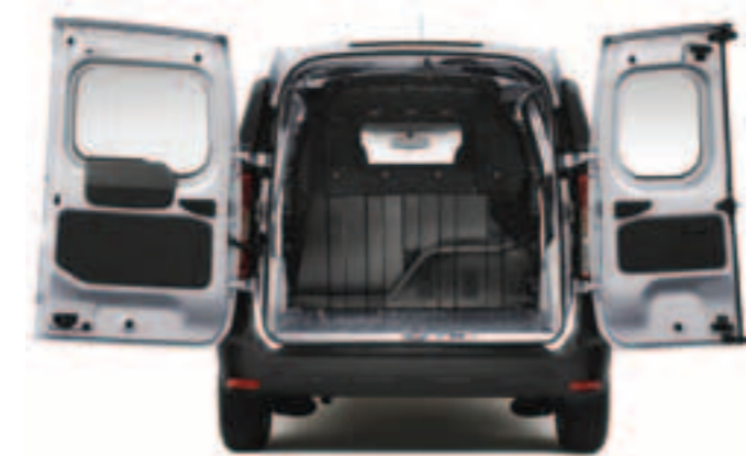
Az aszimmetrikusan osztott ajtószárnyak biztosítják a max. 3,9 m³ térfogatú áru kényelmes be- és kirakódását.
