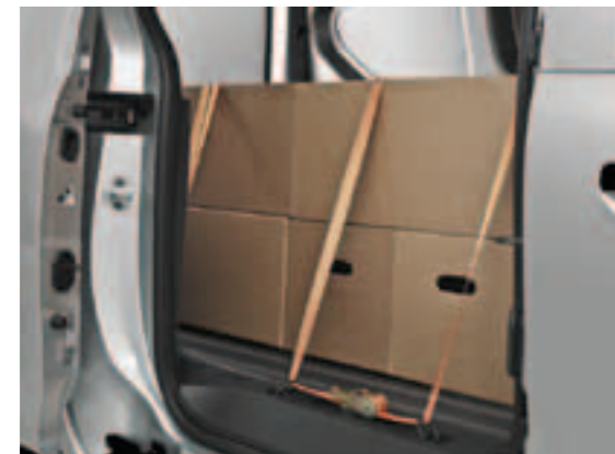
Rakománygörgöző fűlek a raktérben, a biztonságos szállításához.
