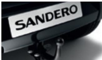
Attelage col de cygne. Il est conçu pour un usage intensif. Le design élégant et le démontage possible de la rotule préservent l'esthétique de votre véhicule.
