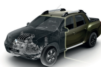
Suspensión delantera tipo McPherson y trasera Multilink
